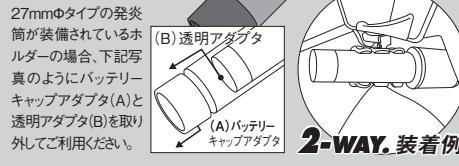
27mmΦタイプの発炎筒が装備されているホルダーの場合、下記写真のようにバッテリーキャップアダプタ(A)と透明アダプタ(B)を取り外してご利用ください。
