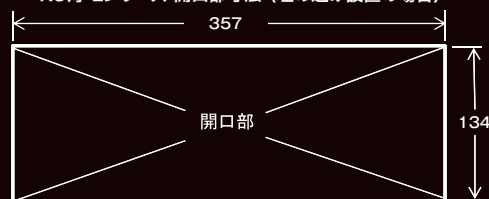
KO灯-Lシリーズ 開口部寸法(埋め込み設置の場合)
